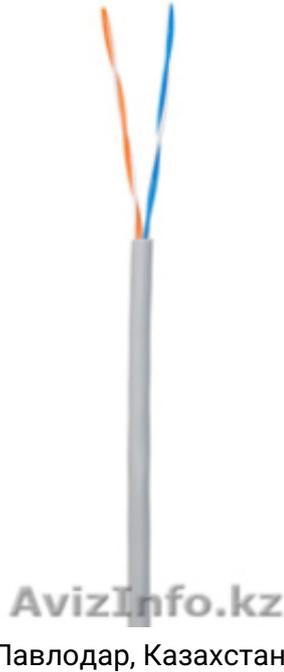
Неэкранированный 2-парный кабель категории 5. Проводники из омеднённого алюминия диаметром 0,50мм поддерживают скорость передачи до 100Мбит/с. Кабель предназначен для внутренней прокладки и рассчитан на температуру до +60°C. Удобный в эксплуатации, благодаря гибкости, и лёгкий по весу кабель является экономичным решением для Интернет-провайдеров. Цвет серый. Поставляется бухтами по 305 метров.
